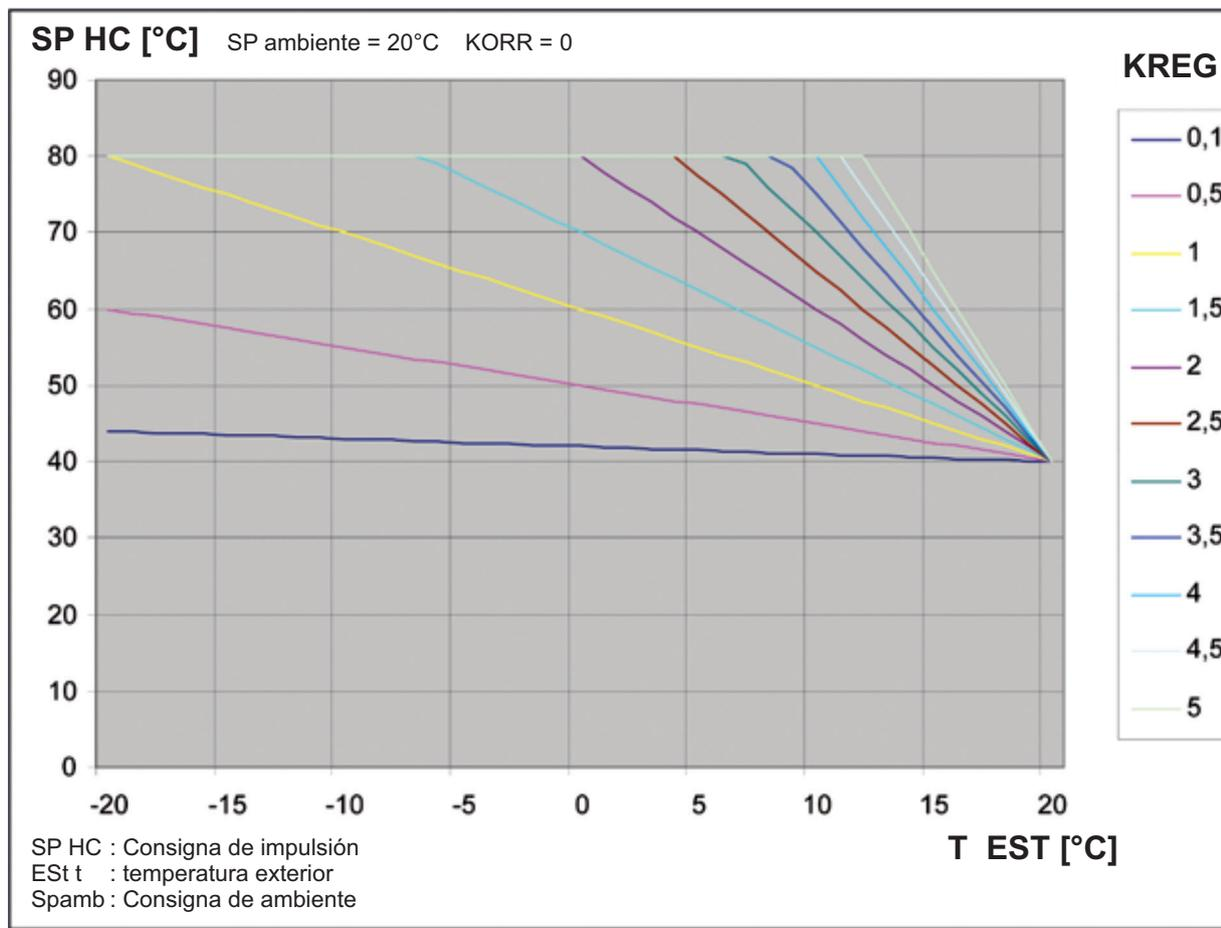
La función tiene como parámetro de entrada (eje x) la temperatura exterior atenuada.
